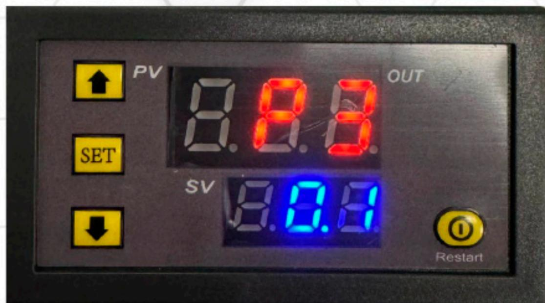
Pressionando novamente a tecla SET mostrara P4, que e o ajuste da correcao da temperatura do sensor interno em relação a um termometro padrao. ( ajuste de temperatura )
