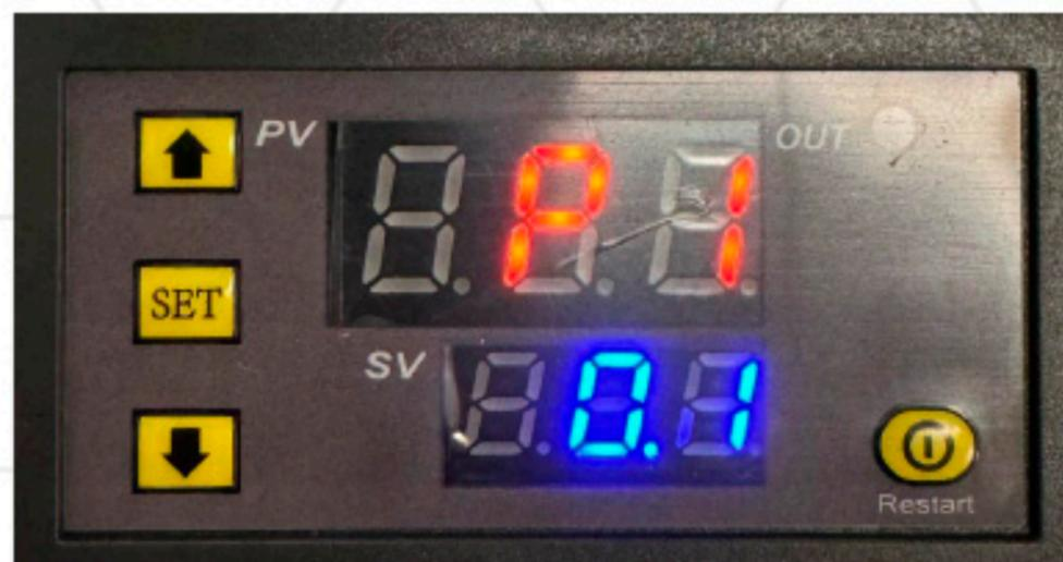
Pressionando novamente a tecla SET mostrara P2, que e o ajuste de temperatura maxima permitida. O equipamento sai ajustado de fabrica para 60°C
